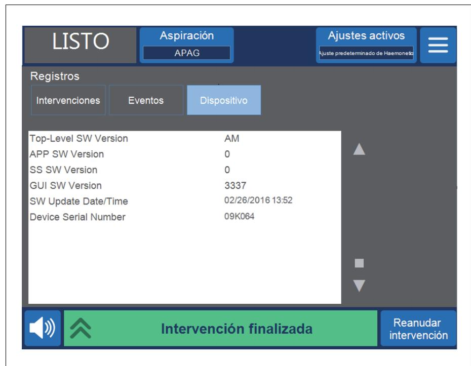
Figura 73, ejemplo de registros del dispositivo
