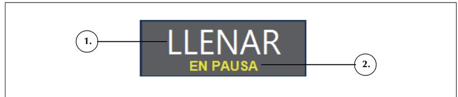
Figura 7, ejemplo del indicador de estado cuando se pone en pausa la fase de llenado
